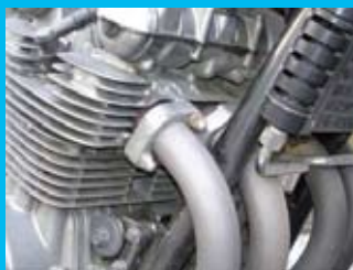
マフラー取り付け部
